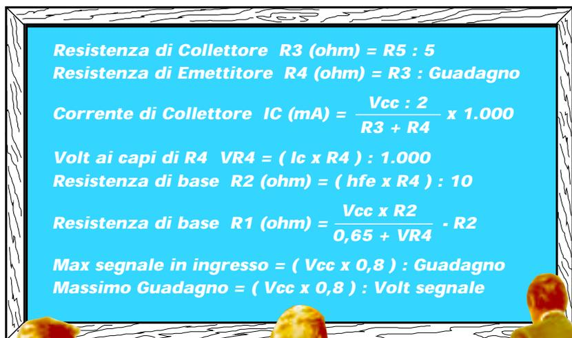
*Resistenza di Collettore*  $R3 \text{ (ohm)} = R5 : 5$
